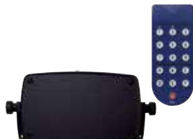
Радарный датчик движения RBM 2 Для импульса «Ворота Откр.» с распознаванием направления движения; макс. монтажная высота: 6 м; пульт ДУ для радарного датчика движения (опция)
