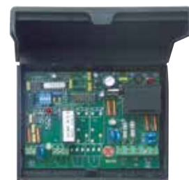
Корпус декодера Для кодовых замков CTR 1b-1, CTR 3b-1, CTV 3-1, CTP 3
